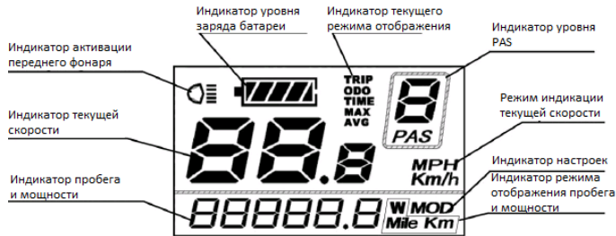
Рисунок 8. Структура дисплея LCD-пульта
